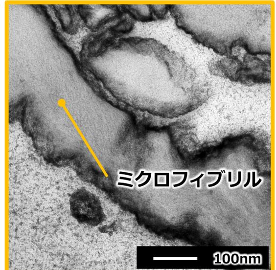
・この食器(ナイフ)は、PLA(ポリ乳酸)/CNFで作られており、TEM(透過型電子顕微鏡)観察により、CNFの分散状態及び内部構造(ミクロフィブリル)を鮮明に確認できます。
